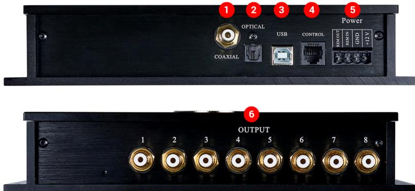
**1. Coaxial.** Разъём для подключения источника цифрового сигнала SPDIF с коаксиальным выходом. Поддерживается цифровой поток в формате стерео. Воспроизведение многоканального сигнала (Dolby Digital, DTS) не поддерживается.
