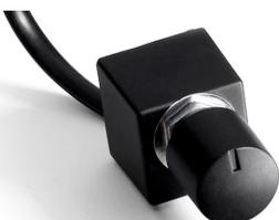
Для подключения к процессору Resolut используется плоский «телефонный» кабель с количеством жил не менее трёх, оконченный разъемом RJ11. Для надёжной работы пульта старайтесь выбрать качественный кабель с медными жилами. Не выбирайте кабель с жилами CCA (Copper Clad Aluminum).
